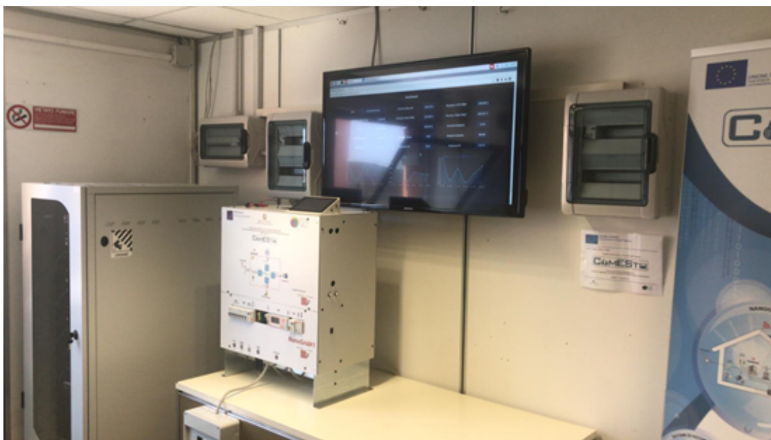
Figura1: Prototipo di laboratorio della DC-nanoGrid nella configurazione PV+lito+carichi critici FONTE: Laboratorio LASEER DIMEG - UNICAL
