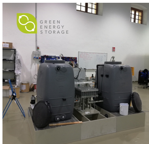
Banco Prova Batterie a Flusso presso i laboratori della Green Energy Storage (GES)
