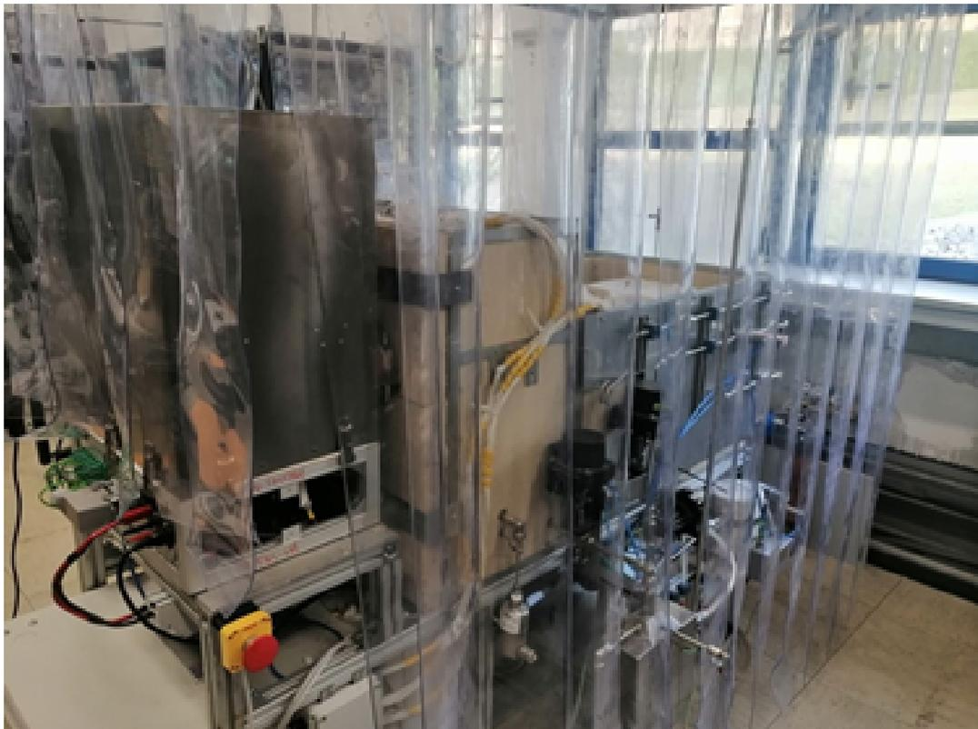
**Figura 2.** Prototipo del sistema P2P basato su cella a combustibile ad ossidi solidi.
