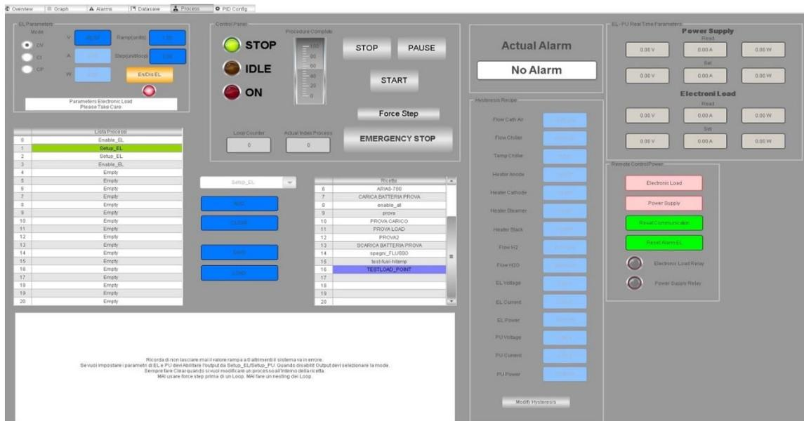
Figura 42 Schermata allarmi del controllo sviluppato per il prototipo H2-SOFC
