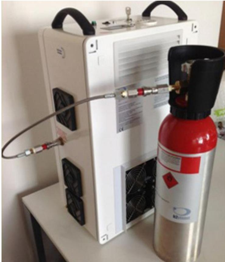
Figura 1 Serbatoi agli idruri per lo storage di idrogeno, connesso con una fuel cell PEM [iii]
