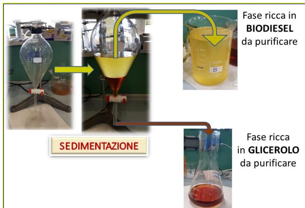
Figura 16. Schema della fase di separazione
