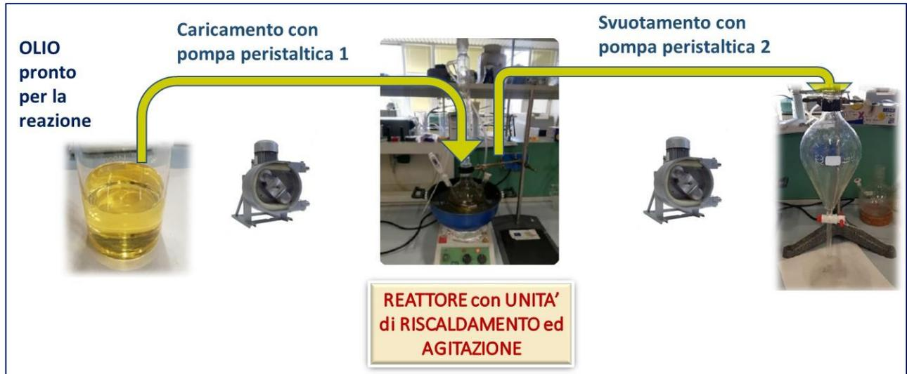
*Figura 9. Schema della fase di transesterificazione*
