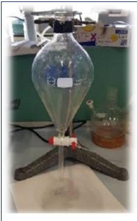
Figura 14. Imbuto separatore utilizzato nel sistema di laboratorio per la fase di sedimentazione
