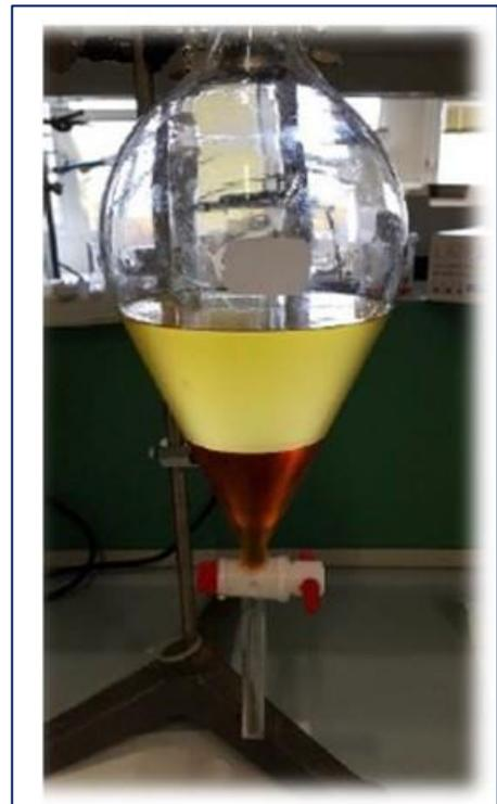
Figura 15 Sedimentazione del campione di Biodiesel dopo 3 ore
