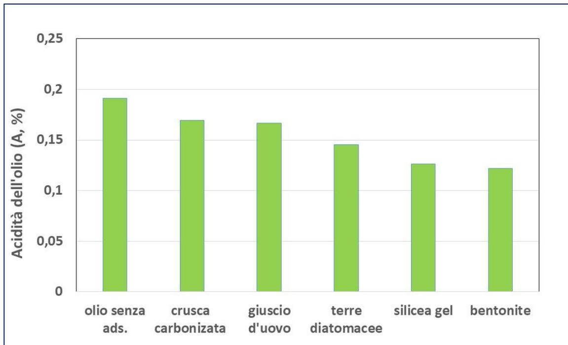
Figura 4. Confronto nell'adsorbimento di FFAs con diversi adsorbenti, naturali ed inorganici, per ridurre l'acidità percentuale negli oli esausti trattati (A%) derivante da FFAs.
