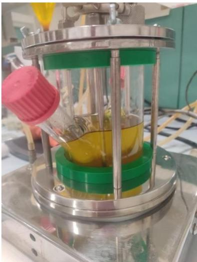
*Figura 8. Reattore automatizzato*
