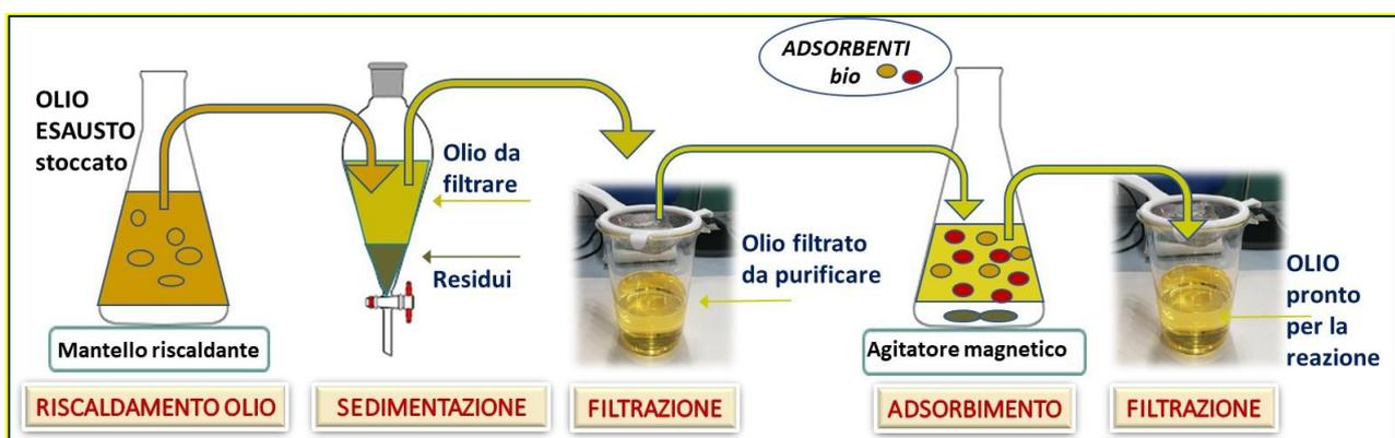
Figura 5. Pretrattamento degli oli esausti raccolti. Schema del processo e articolazione delle diverse fasi
