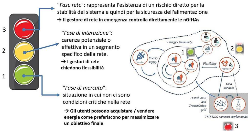
FIGURA 15 - INTEGRAZIONE TLM NELLA GESTIONE DELLA RETE ELETTRICA
