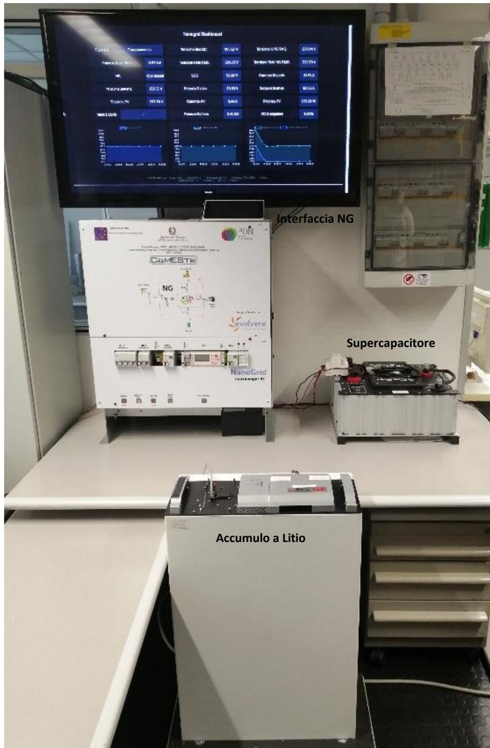
Figura 107 Configurazione dimostratore NG2.
