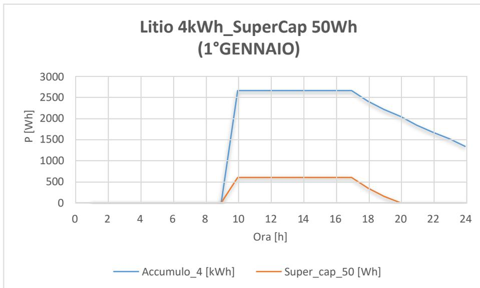
Figura 55 - Accumulo litio\_supercap (stato iniziale scarico) 1° gennaio\_Consumager#2.
