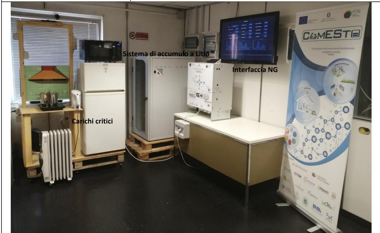
Figura 105 Configurazione dimostratore NG1.
