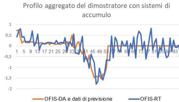
Figura 4-11 Profilo aggregato del dimostratore, confronto tra il caso di dati di previsione ed il caso di dati misurati con correzione degli sbilanciamenti
