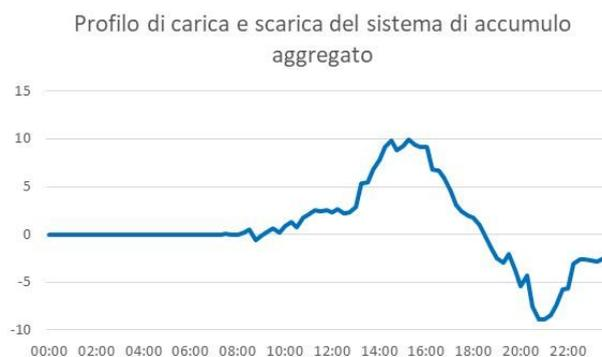
Figura 4-5 Profilo di carica e scarica dei sistemi di accumulo (profilo aggregato)
