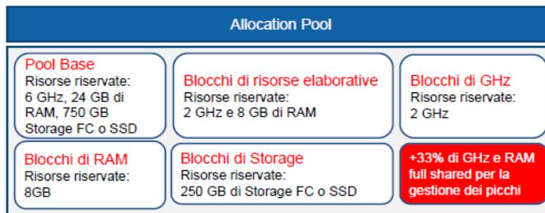
Figura 10.1-1 blocchi di risorse configurabili per l'utente nel servizio Self Data Center
